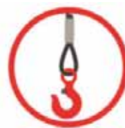
Работа при отсутствии защелки на крюках
